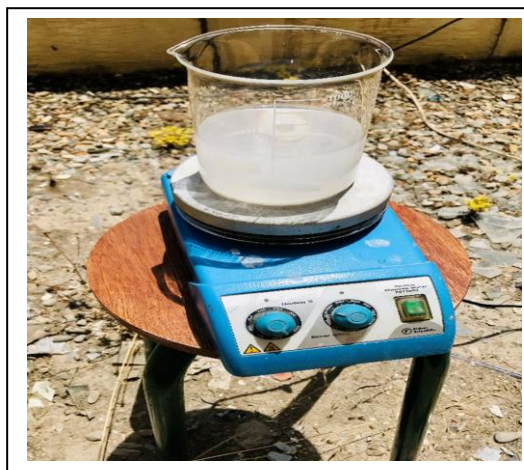
Figure II.2 : Dispositif expérimental de la photodégradation sous rayonnement solaire
