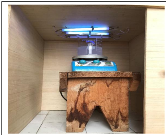
Figure II.1 : Dispositif expérimental de la photodégradation avec l'utilisation des lampes UV
