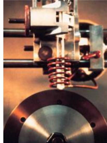
Figure 1 : Schéma de principe dispositif de trempe par Melt-Spinning
