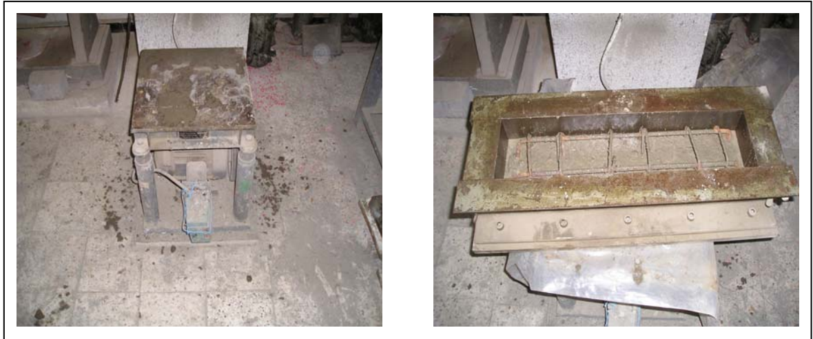
Figure III.7. Vibration du béton à l'aide de table vibrante
