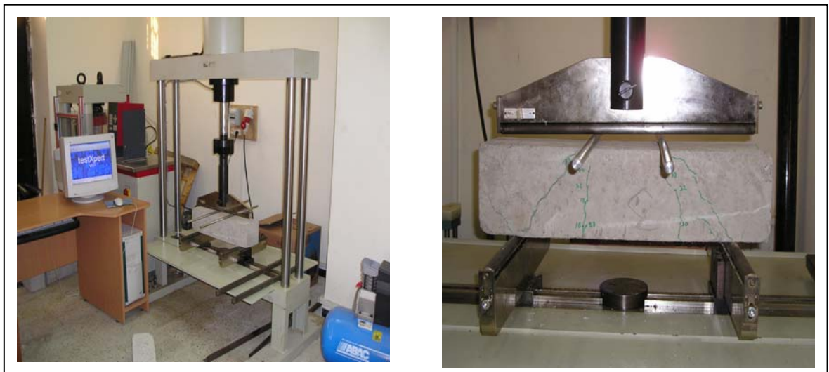
Figure III.11 Appareillage d'essai et fissuration des éprouvettes prismatiques par essai de flexion
