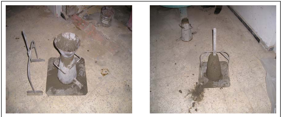
Figure III.5. Affaissement du béton mesuré par le cône d'Abrams
