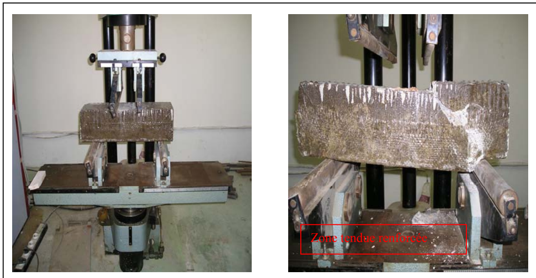
Figure IV.19. Mode de rupture du béton réparé/renforcé par demi chemisage
