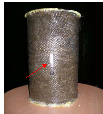
Figure IV.1.d. Jauge extenso métrique collée à la surface de l'éprouvette
