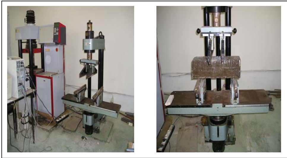
Figure IV.7. Machine de flexion de capacité 200kN – TONI TECHNIK –
