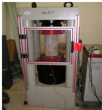
FigureIV.1.c. Machine de compression 'TONI TECHNIK' Capacité3000KN
