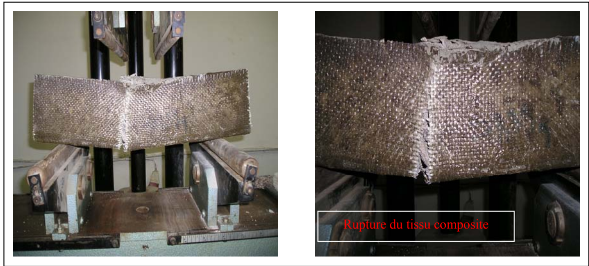
Figure IV.20. Mode de rupture du béton non fissuré renforcé par chemisage complet
