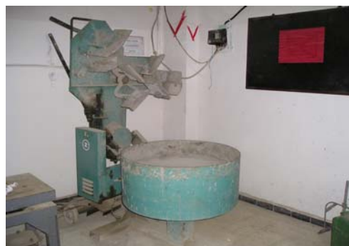
Figure III.4 Malaxeur à axe vertical de capacité 65l
