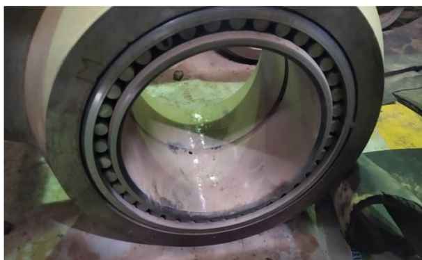
Figure 27: Les roulements des bielles
