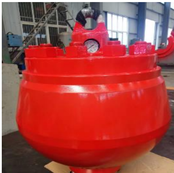
Figure 34 : L' amortisseur de pulsations
