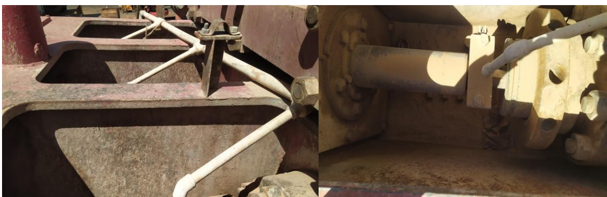
Figure 31 : Système de lubrification et de refroidissement
