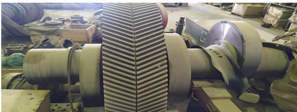
Figure 23: L'arbre petite vitesse ou vilebrequin
