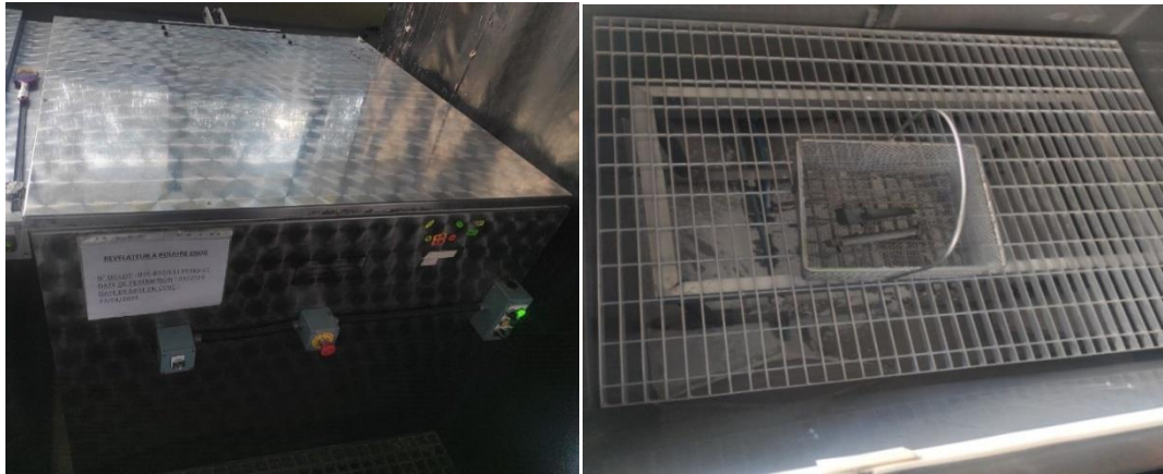
Figure III.14 : Application du révélateur à poudre
