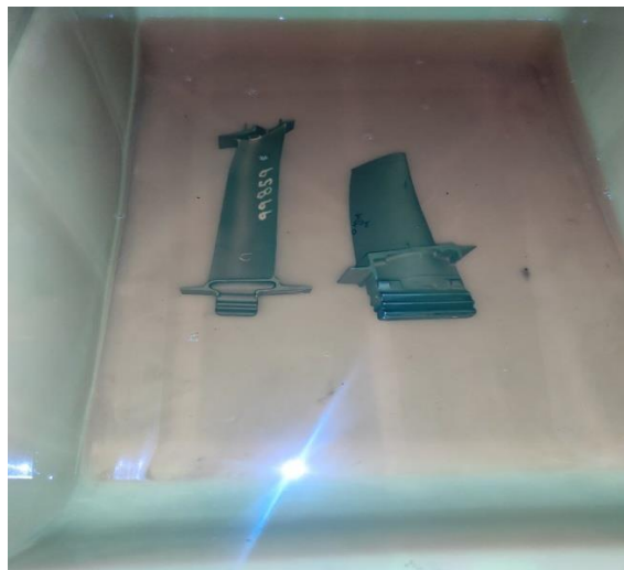
Figure III.11 : Application de le pénétrant RC77
