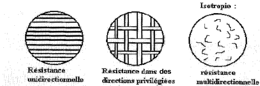
Figure. 1.8 : Architecture du renfort
