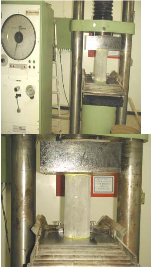
Figure IV.2 . (A) - Machine de compression ; (B) - Ajustement de l'éprouvette
