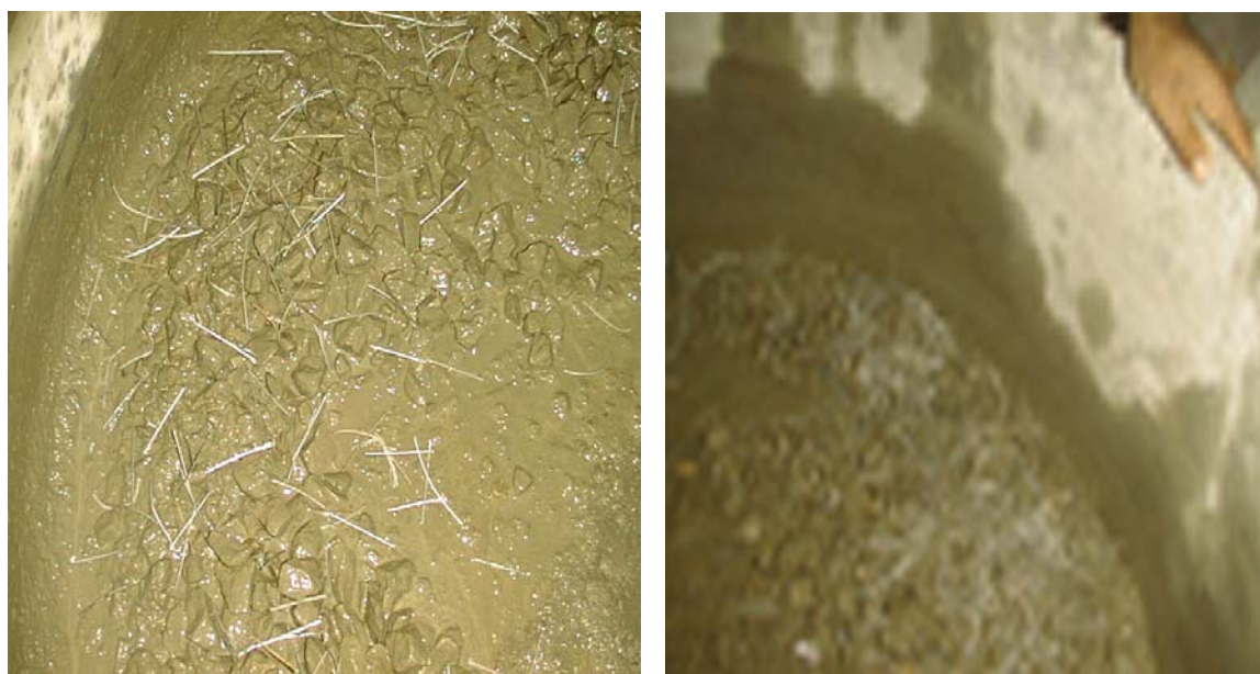
A B Figure III.8. Introduction de fibres au cours de malaxage A-30% de fibres B-100% de fibres
