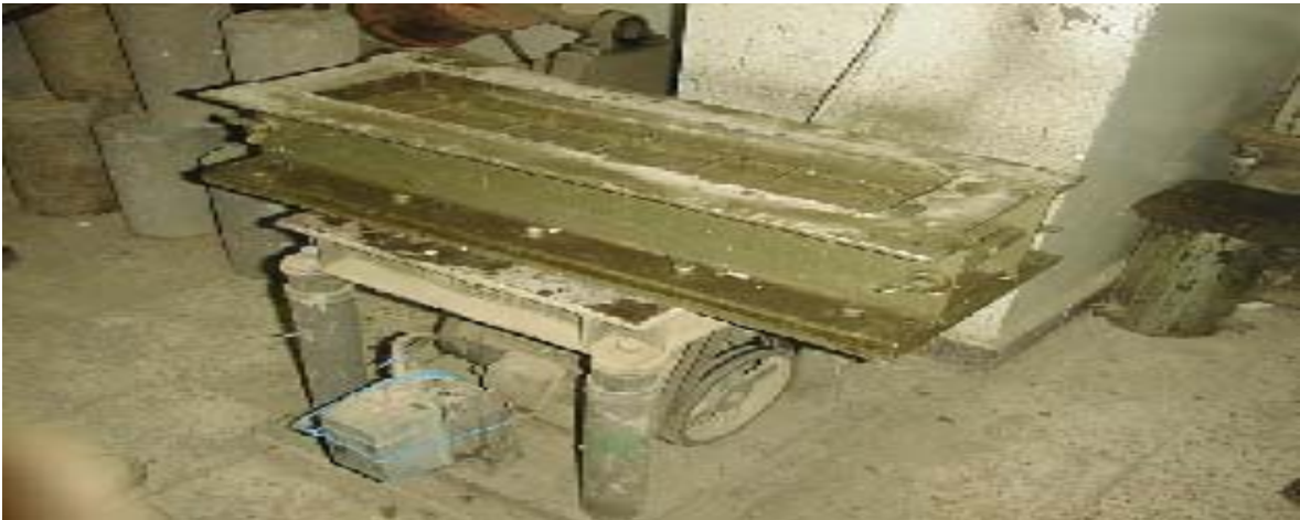
Image A.5. Vibration par table
