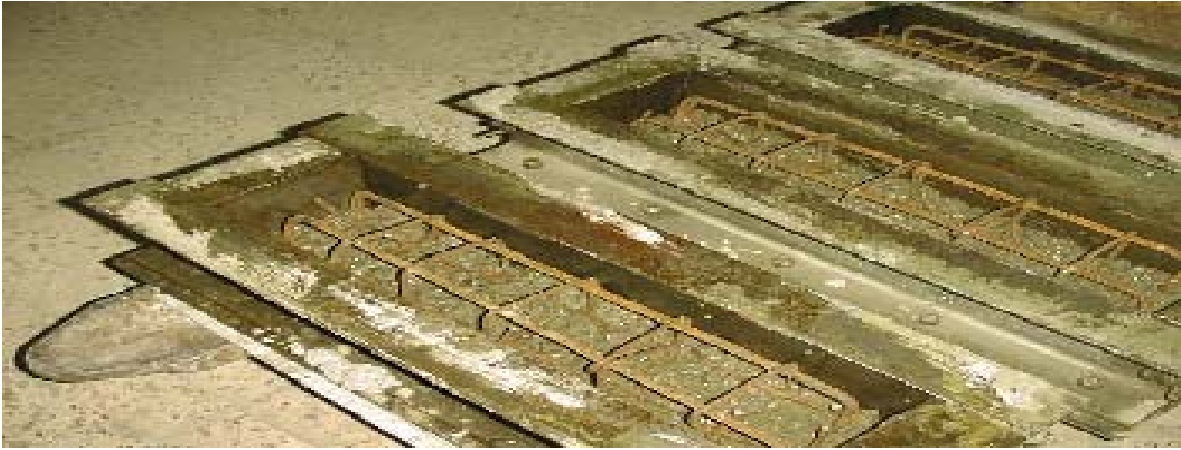
Image A.4. Remplissage des moules
