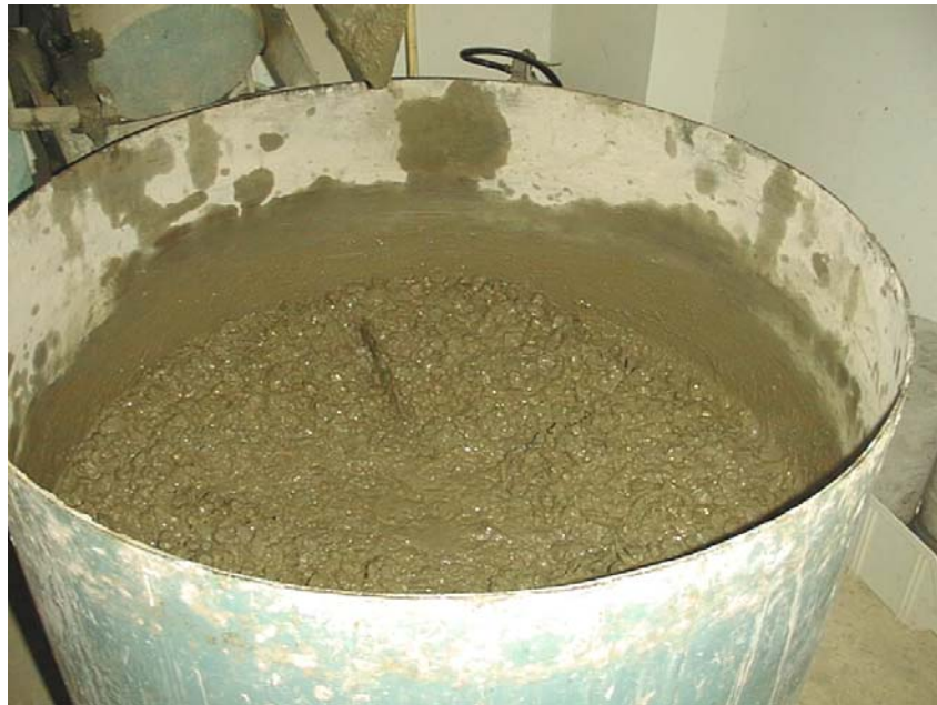
Figure III.7 .Malaxeur à axe vertical : Malaxage du béton témoin
