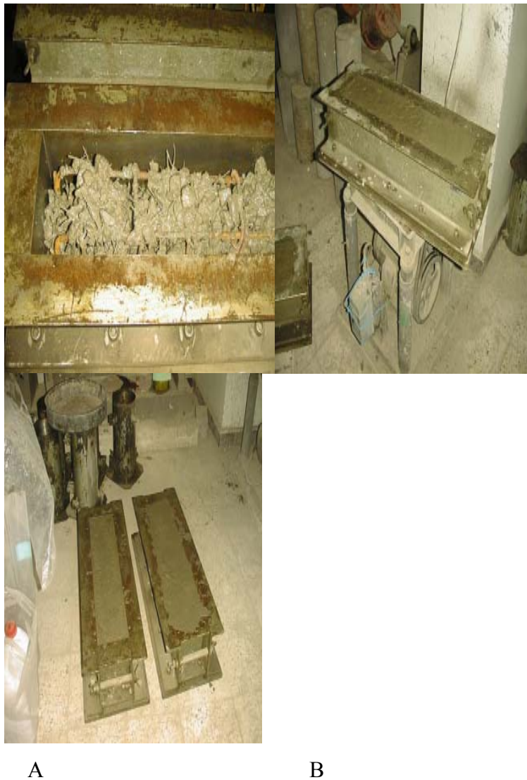
Figure III.9. Etapes de préparation des éprouvettes A : remplissage de béton armé de fibres B : table de vibration C : phase finale de remplissage des moules.
