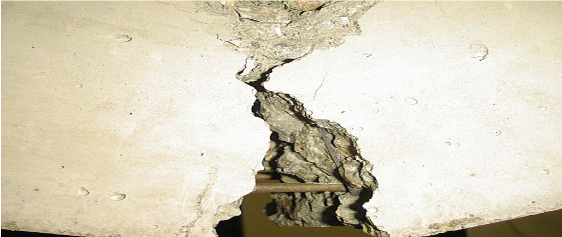
Image A.10. Mode rupture des éprouvettes en béton armé
