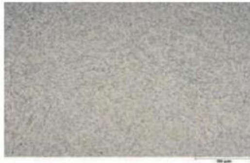
Figure V. 3: Structure d'un acier AISI H11 à l'état recuit.
