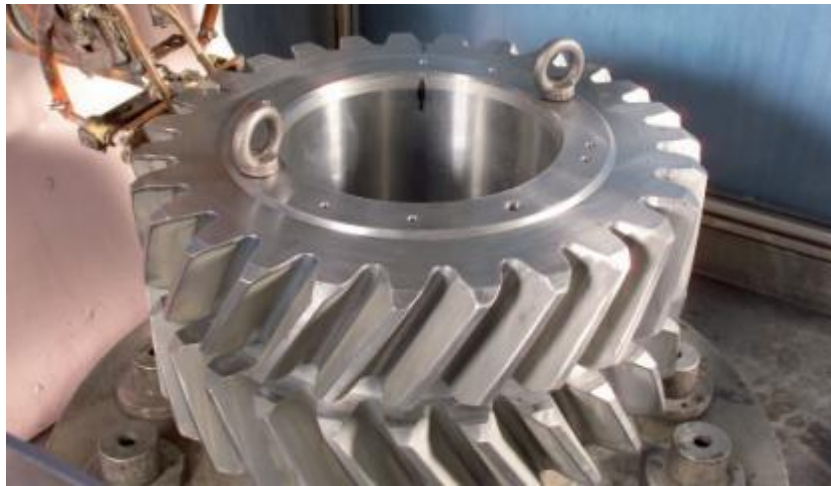
Figure V. 8: Roue dentée trempée dent par dent.[12]
