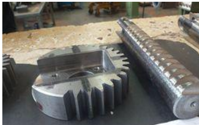
Figure II. 19: Le couple d'engrenage du chariot arrière de la presse à genouillère Gräbener GK 360T.
