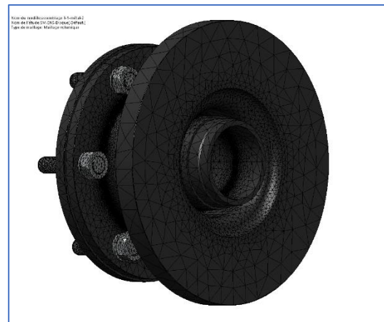
Sous-ensemble disque-moyeu-goujon
