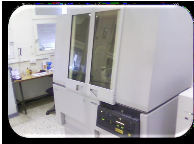
Figure 16 : Diffractomètre des rayons X Philips X'Pert Pro.
