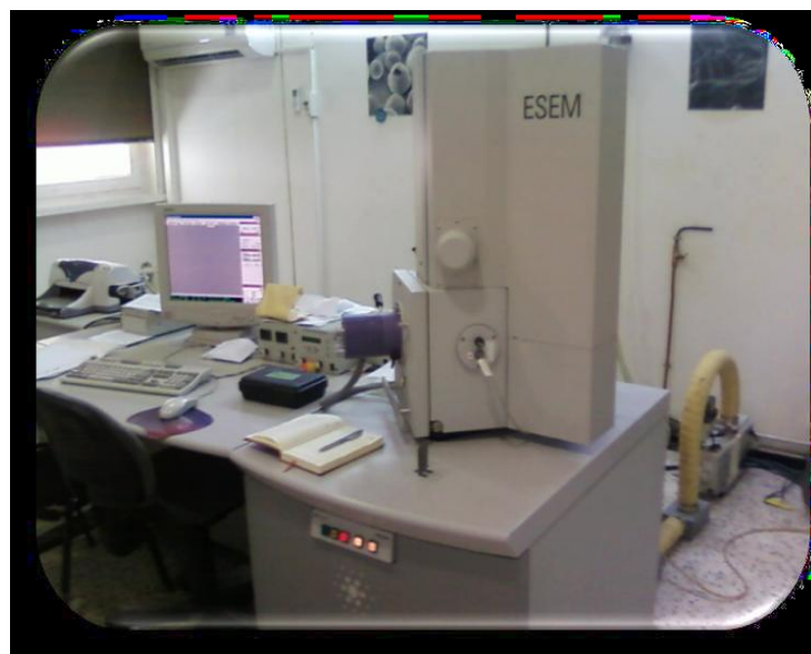
Figure 19: Microscope électronique à balayage Philips ESEM XL 30
