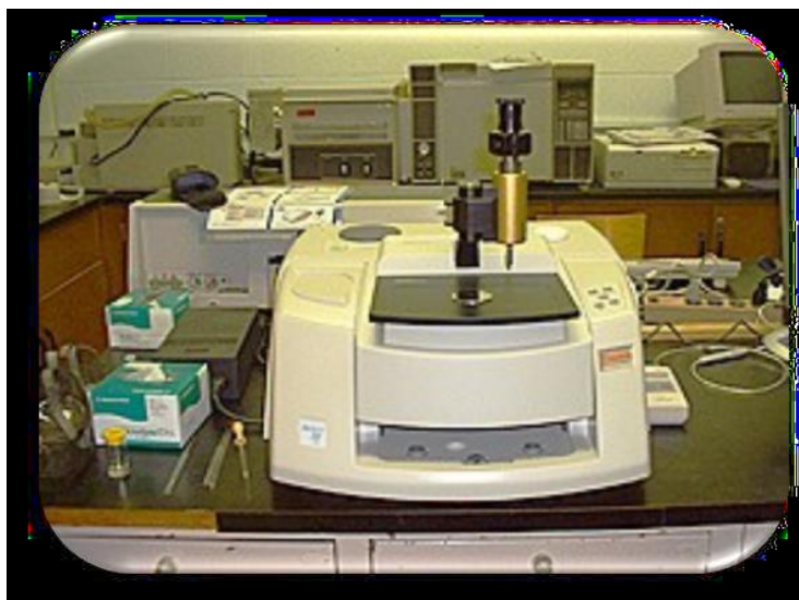
Figure 17: Spectromètre infrarouge FTIR Nicolet 380.
