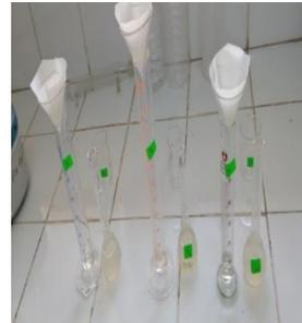
Figure 29. Les solutions d'analyse HMF. Figure 30. Filtration de solution pour l'HMF.
