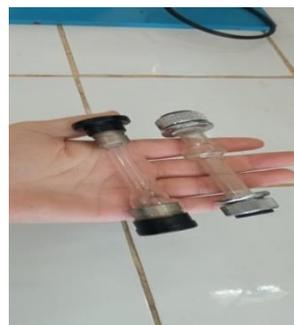
Figure 28. Tube de Polarimètre de 1 dm.
