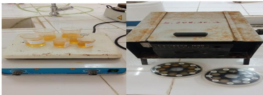
**Figure IV36. Analyse de la couleur des miels par comparateur Lovibond (1000 COMPARATOR).**
