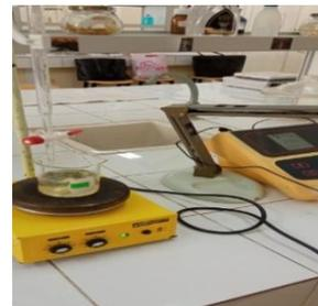
Figure 20. pH mètre étalonné (JENWAY). Figure 21. Mesure d'acidité libre.
