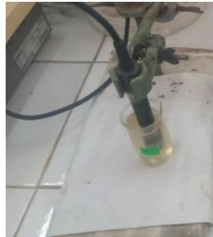
Figure 23. Mesure de Conductivité.
