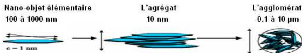
**Figure I.5 :** Illustration de l'organisation à différentes échelles d'un silicate lamellaire
