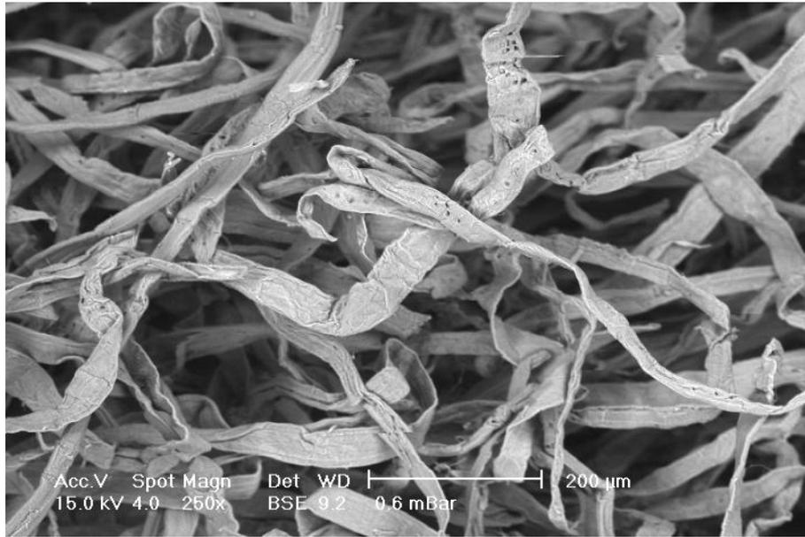
**Figure IV.2:** Micrographie des fibres de cellulose imprégnées par les ammoniums quaternaires.
