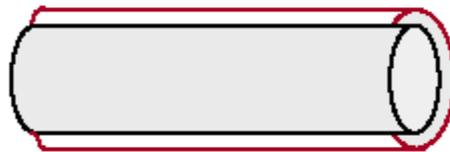
**Figure I.1:** Schéma d'une fibre imprégnée d'un agent antibactérien par dépôt [15]
