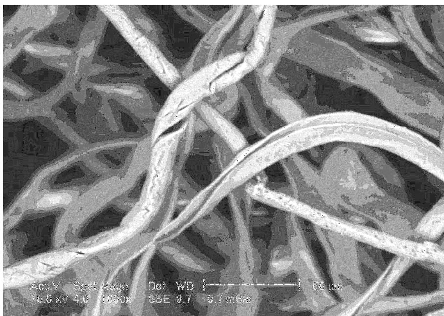
**Figure III.7:** Micrographie de la cellulose imprégnée d'Aliquat 1529
