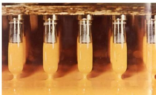
*Figure III.05 : Mise en forme des gélules par moulage par trempage*
