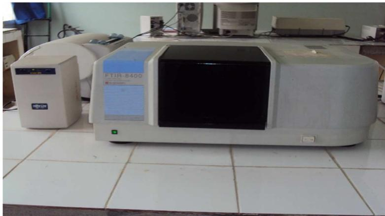
*Figure IV.02 : Spectromètre FTIR 8400 SHIMADZU*
