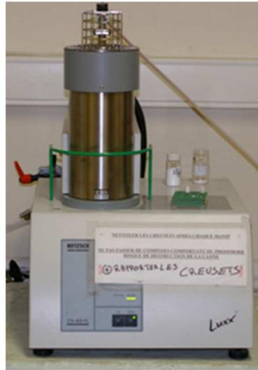
*Figure VI.04 : Appareil ATG-DSC NETZSCH STA 409 PC*
