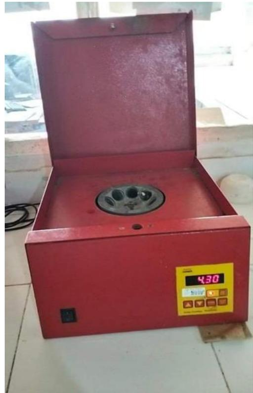
Figure N°5 : Centrifugeuse de Gerber
