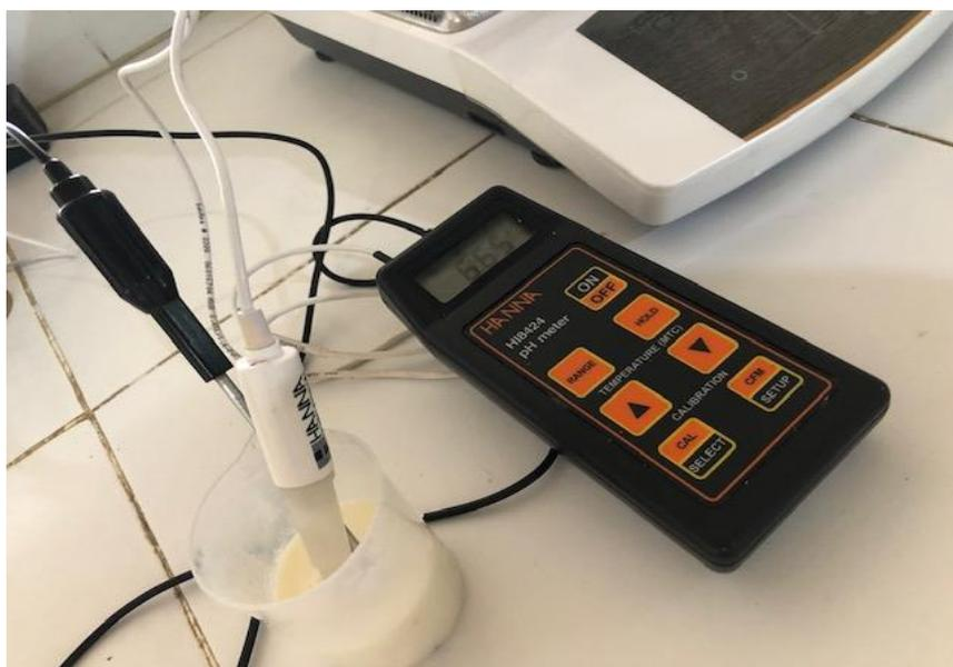
Figure N°1: Mesure du pH par un pH mètre
