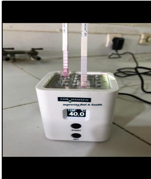
Figure N°8 : Appareil Beta Star 25
