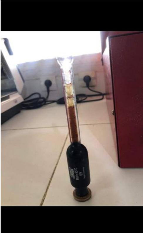
Figure N°4 : Butyromètre.
