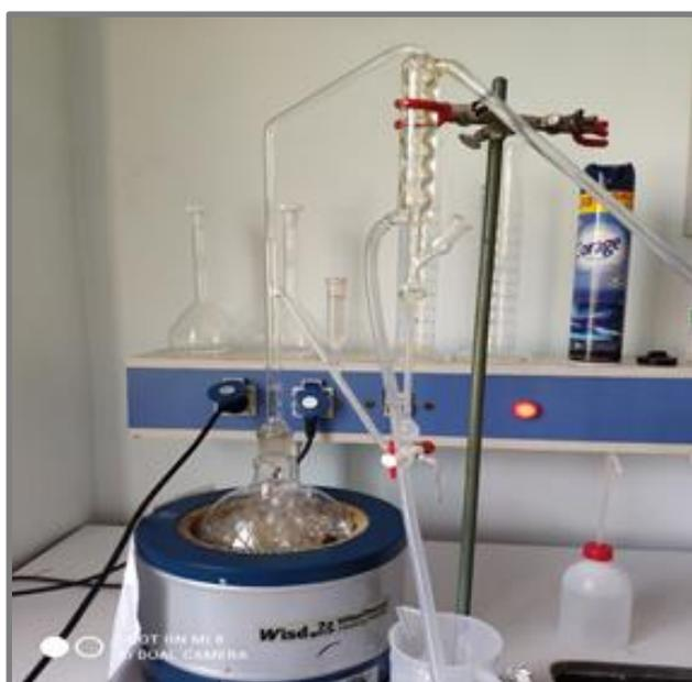
**Figure 20:** Dispositif d'extraction de l'huile essentielle (photo originale, 2023).
