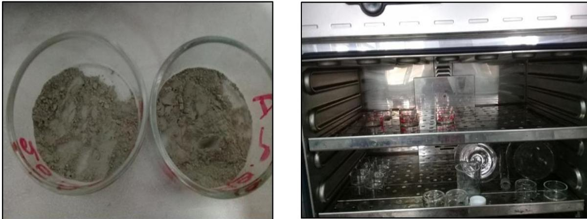
**Figure 9** : Détermination de la matière sèche et eau dans les sédiments.
