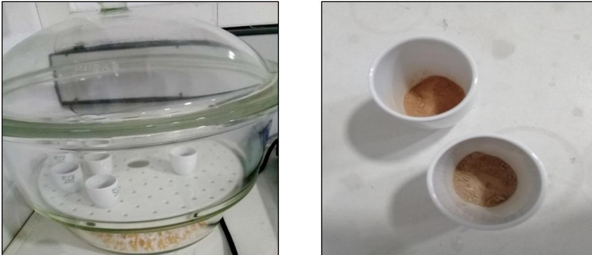
**Figure 10** : Détermination de la perte au feu dans les sédiments.
