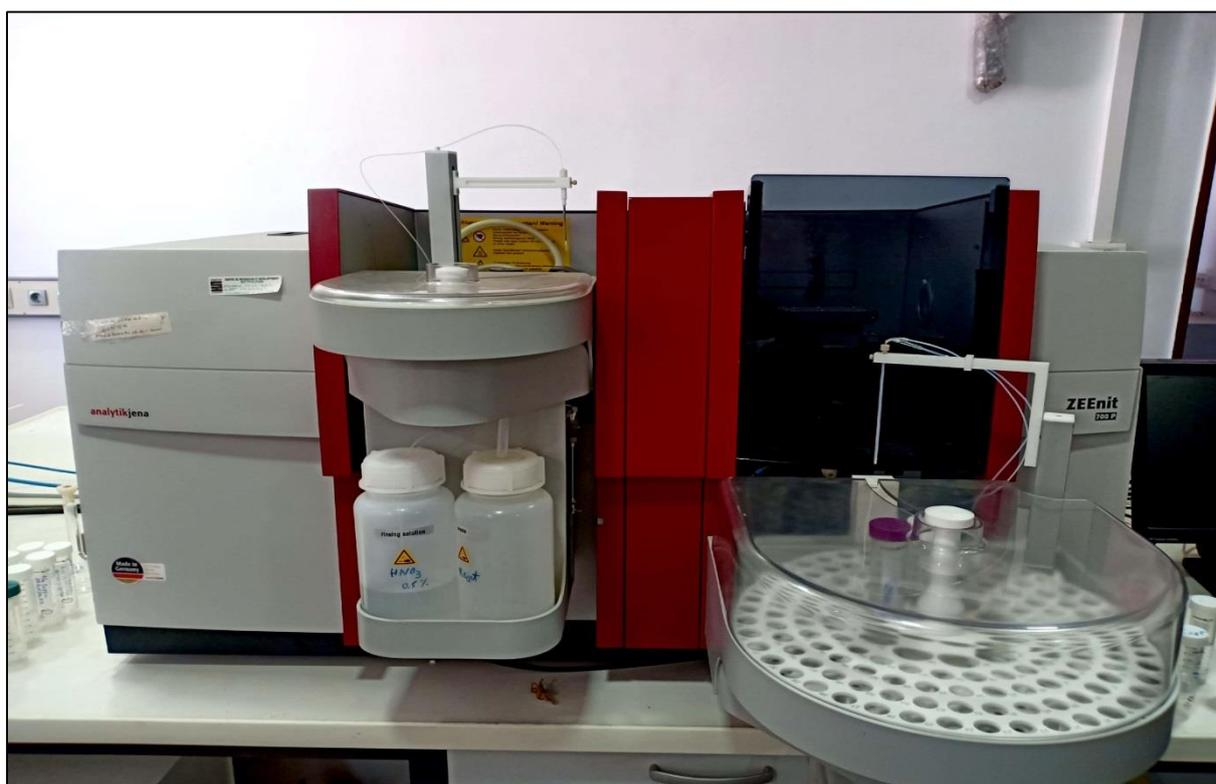
**Figure 12 :** Spectromètre d'absorption atomique à flamme **Analytikjena (ZEEnit700)**.
