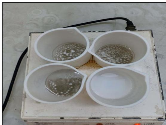
**Figure 11** : Minéralisation et mise en solution des sédiments
