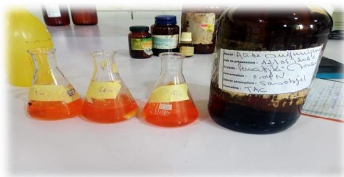
**Figure.IV.7.** Détermination de TAC.
