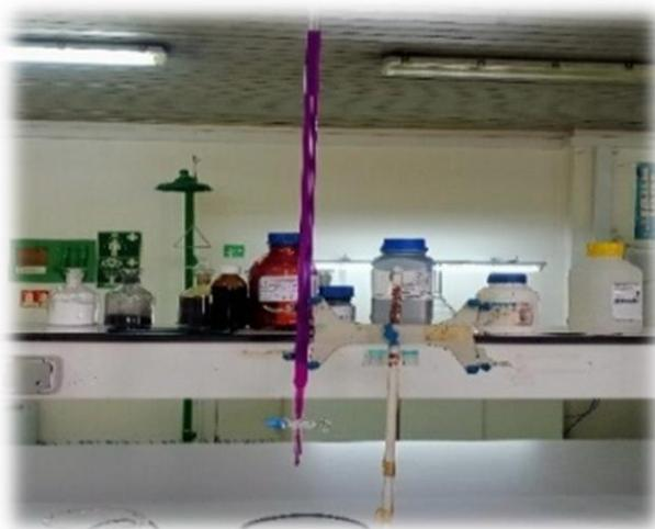
**Figure.IV.14.** Dosage de MO par permanganate de potassium.
