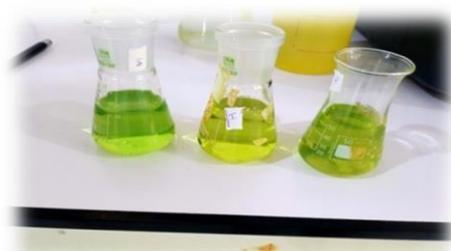
**Figure.IV.13.** Dosage de l'ammonium par spectrophotométrie moléculaire.
