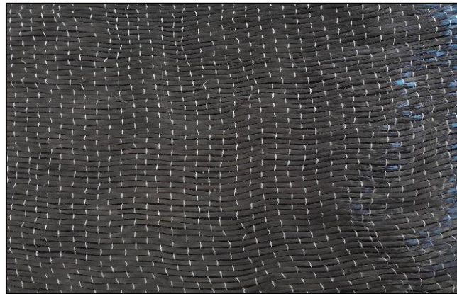
Figure III.6 : Le matériau composite utilisé (SikaWrap®-230 C/45)
