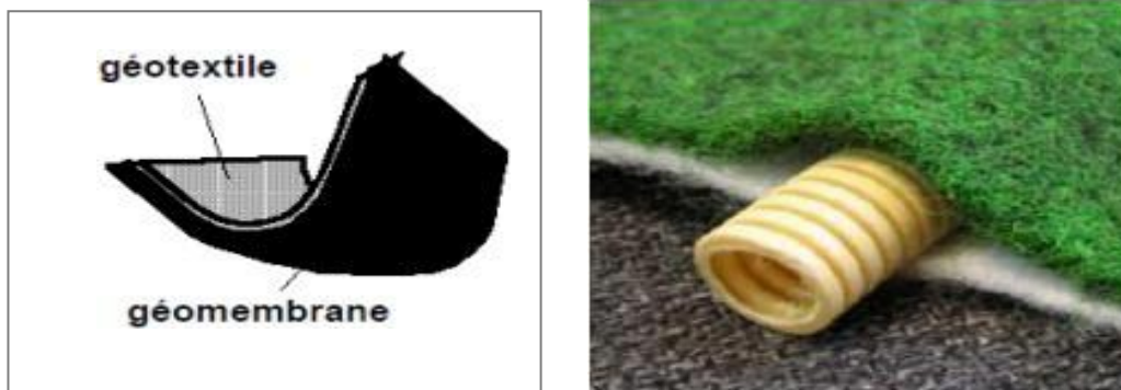
Figures II.15 (a) et (b) : Structure d'un géocomposite et emplacement [20]
