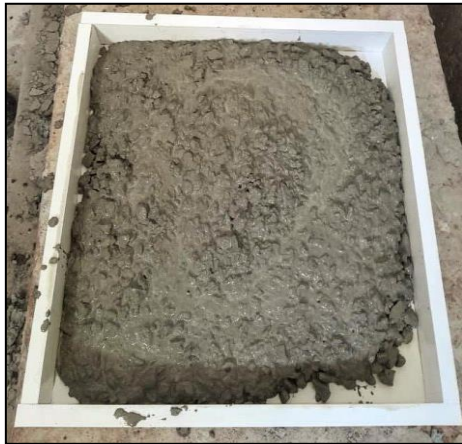
Figure III.25 : Coulage du béton à 1/3 de la base
