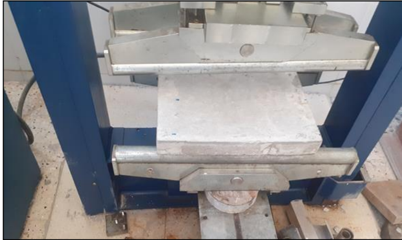
Figure IV.13 : Placement axé de dalle pour essai de flexion 4 points
