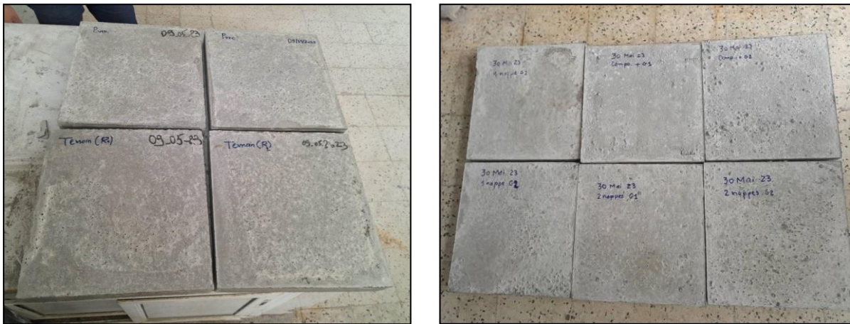
Figure III.29: Démoulage des dalles après durcissement du béton
