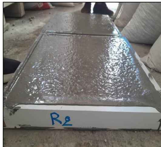
Figure III.28 : Dallette coulée et vibrée
