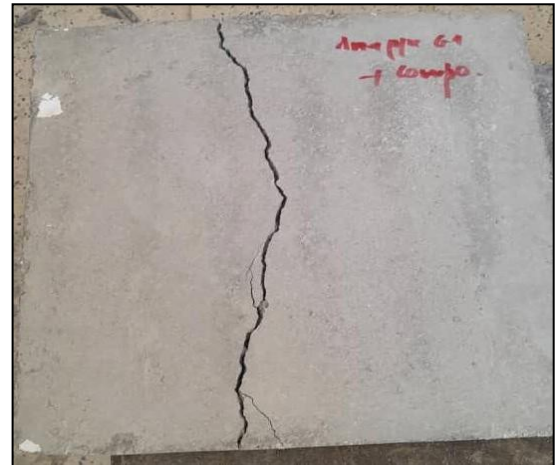
Figure IV.28 Apparition et évolution de la fissure Figure IV.29 Fissure de rupture lors de l'essai
