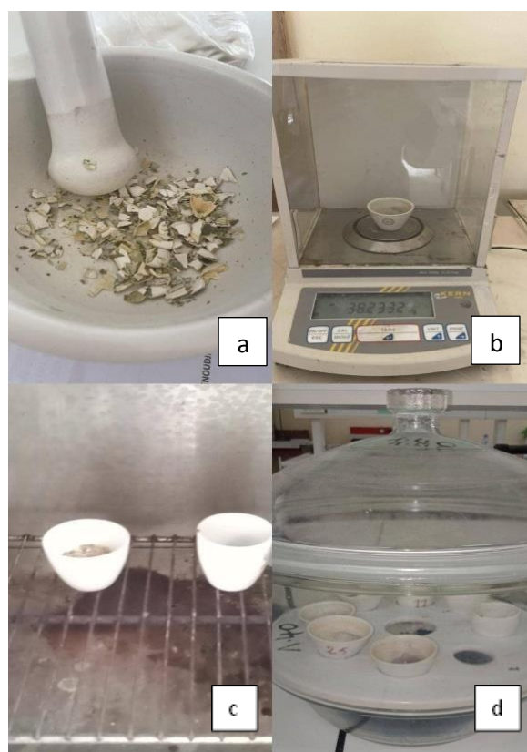
Figure II.4 : Protocole de mesure de la teneur en eau et en matières volatiles.
