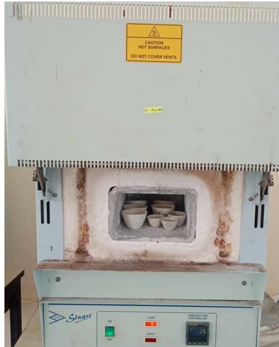
Figure II.5 : Calcination de la matière sèche dans un four à moufle.
