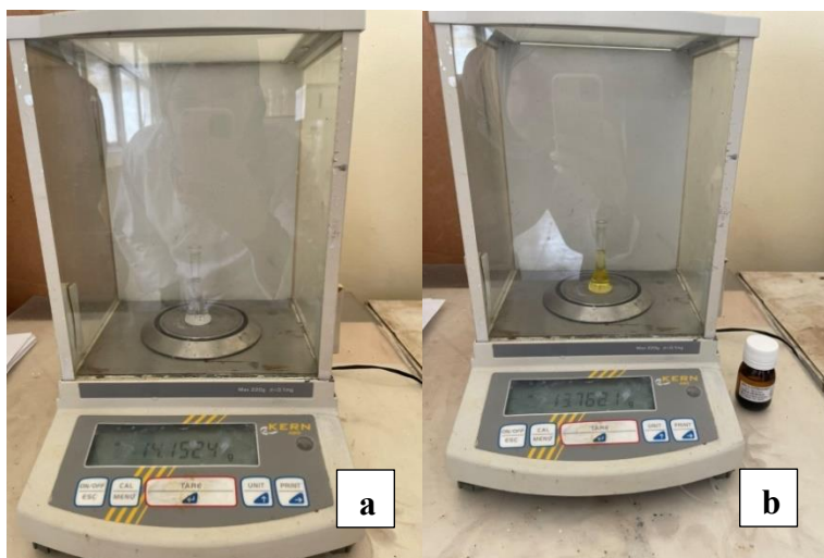
Figure II.6 : Etapes de mesure de la densité des HVs (a : pycnomètre rempli d'eau ; b : pycnomètre rempli d'HV).
