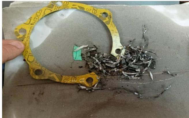
Photo V.3 : l'usure des turbines du convertisseur de couple et du coupleur hydrodynamique
