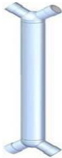
Figure III.6. Échangeur de chaleur de l'électrolyte
