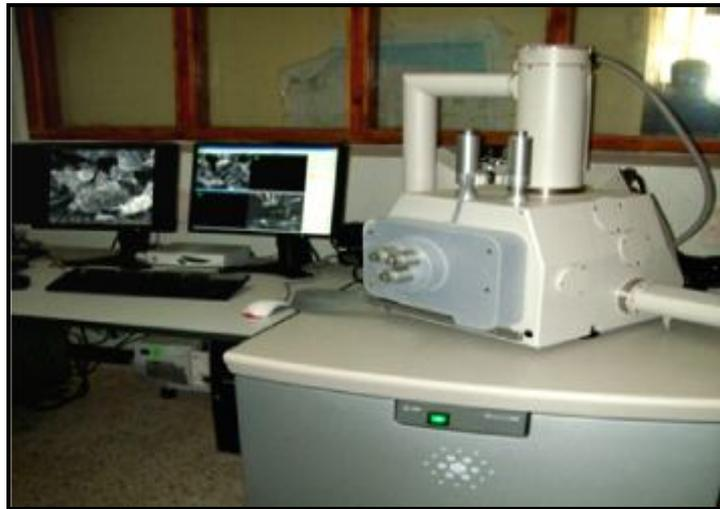
**Figure II. 9:** Le microscope électronique à balayage Quanta 600.
