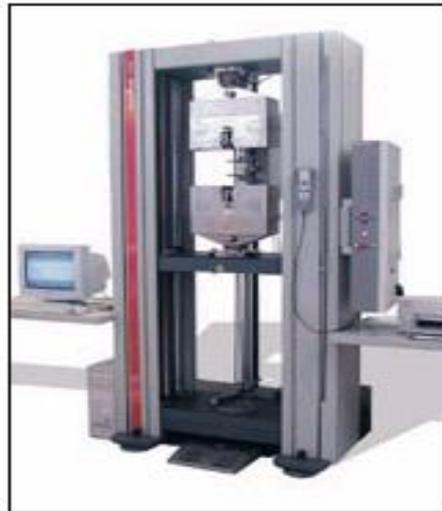
**Figure II.7:** Machine d'essais universelle électromécanique de marque Zwick/Roell Z050.
