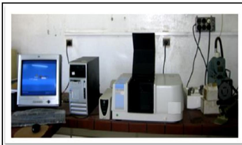
**Figure II.2:** Spectromètre FT-IR SHIMADZU 8400 S.
