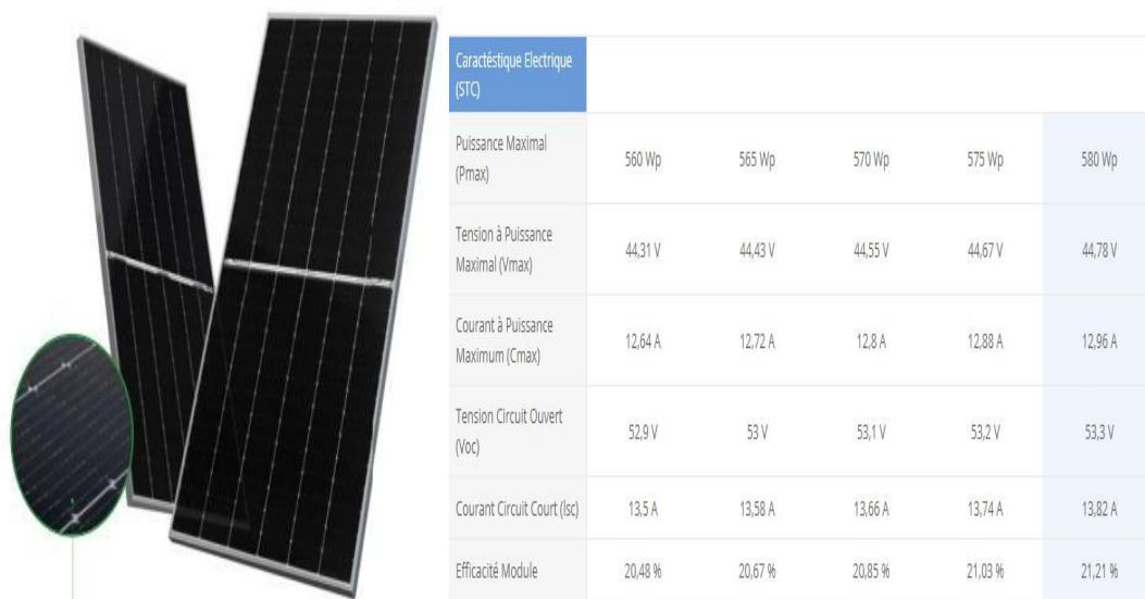
Figure 3.7 panneau 78M-7RL4-V-560-580M et ses caractéristiques électriques
