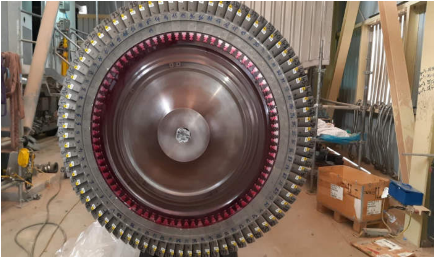
Figure II.21 : les aubes de la turbine.
