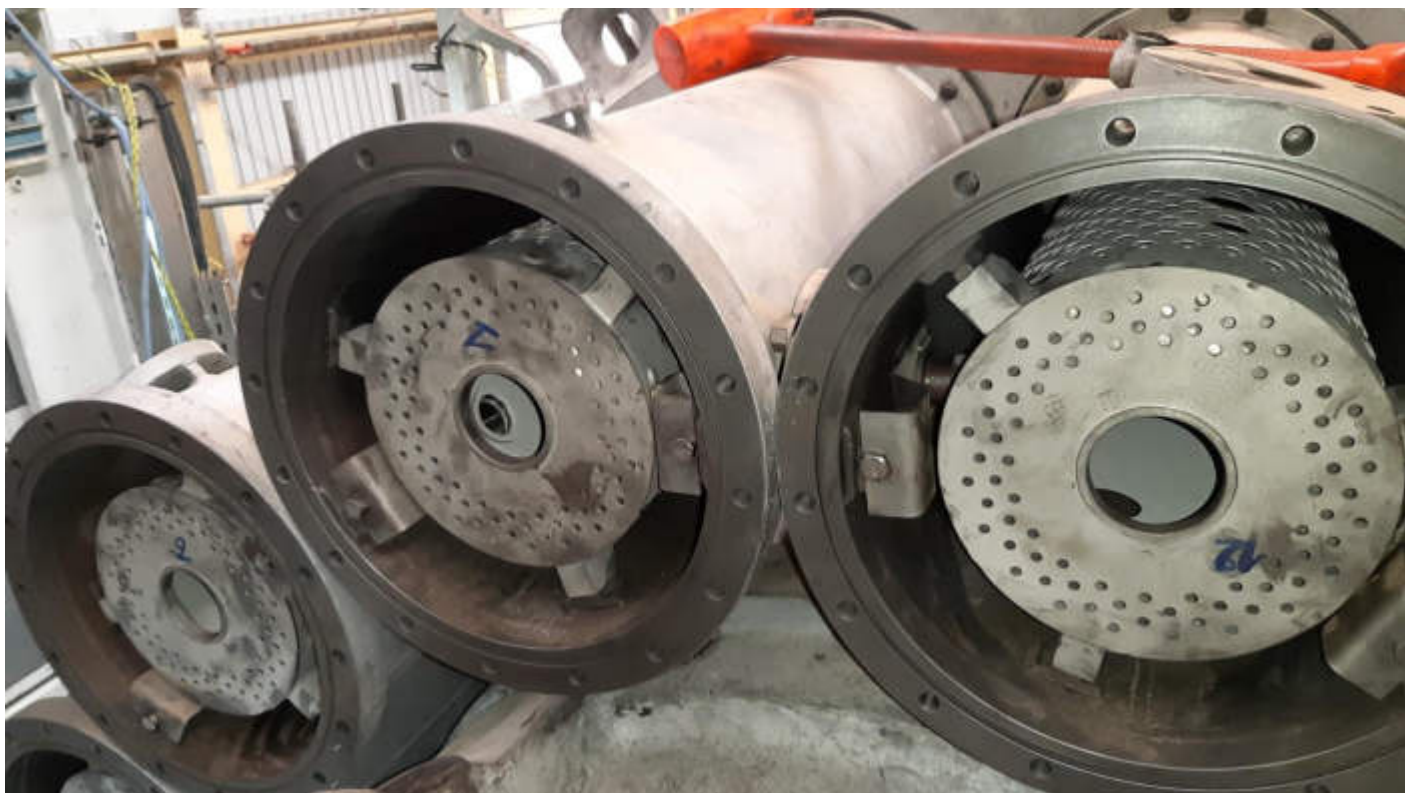
Figure (II.13) chambre de combustion de la turbine à gaz MS 5002C.
