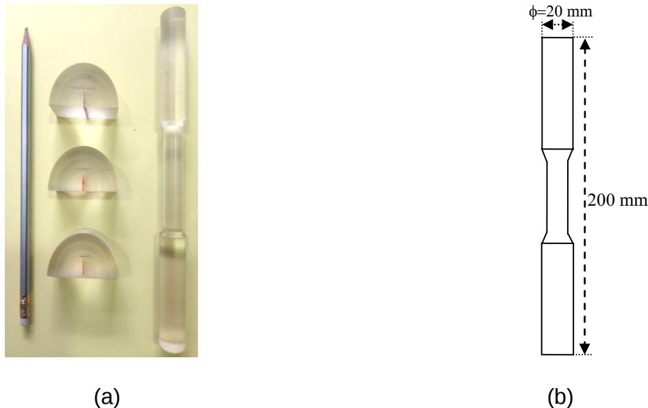
Figure II.4 : Échantillons de PMMA synthétisés (a), schéma de la dimension de l'échantillon de tension cylindrique (b) et de flexion à trois points (c).
