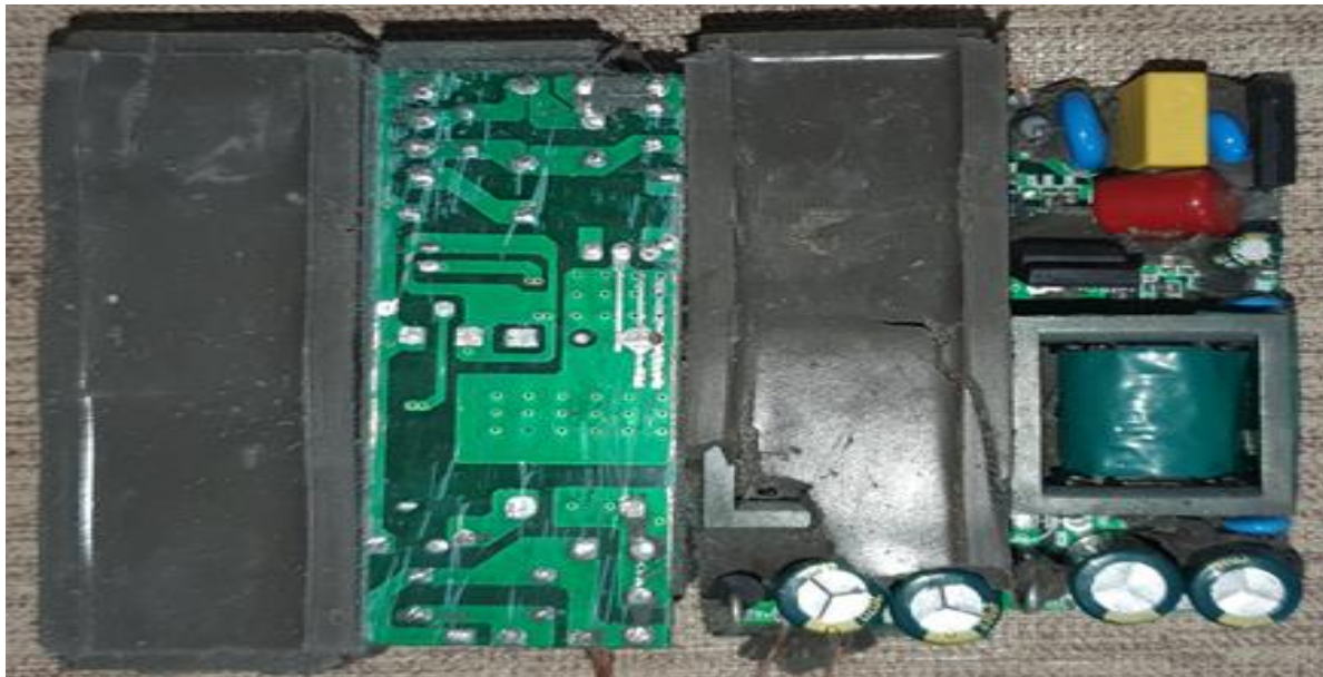
Fig. IV-39 : Composants électroniques d'un luminaire LED 200 Wat – quatre (04) Drivers en recto verso (après enlèvement de l'enrobage)
