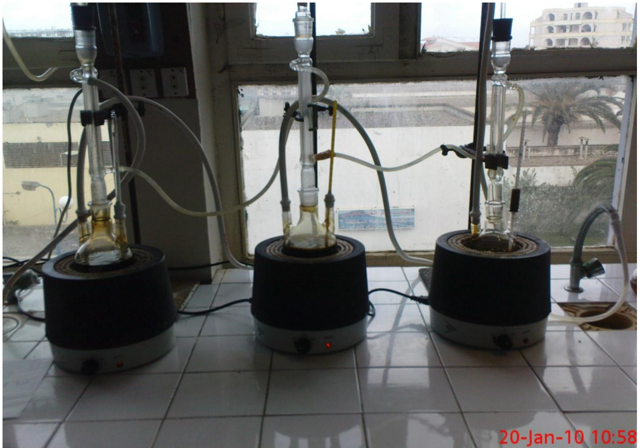
Figure 7 –2– Montage du test de l'oxydation des huiles lubrifiantes d'après la norme ASTM.
