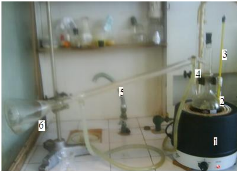
Figure II-4 : Schéma de l'installation de la distillation de produit d'alkénylation
