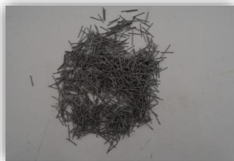
**Figure III.6** Fibres DRAMIX 25mm
