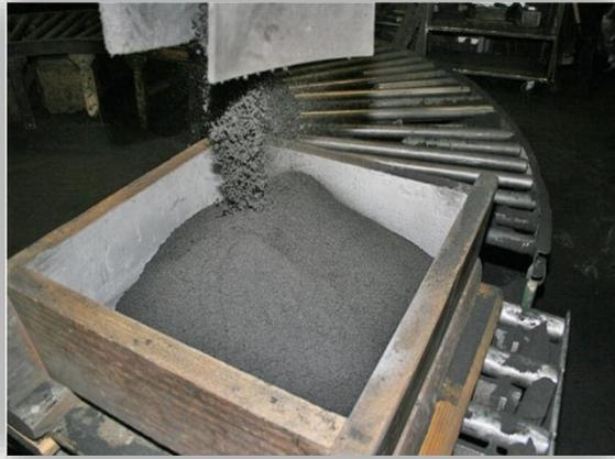
**Figure II.5** une boîte de moulage est remplie de sable de fonderie [19]
