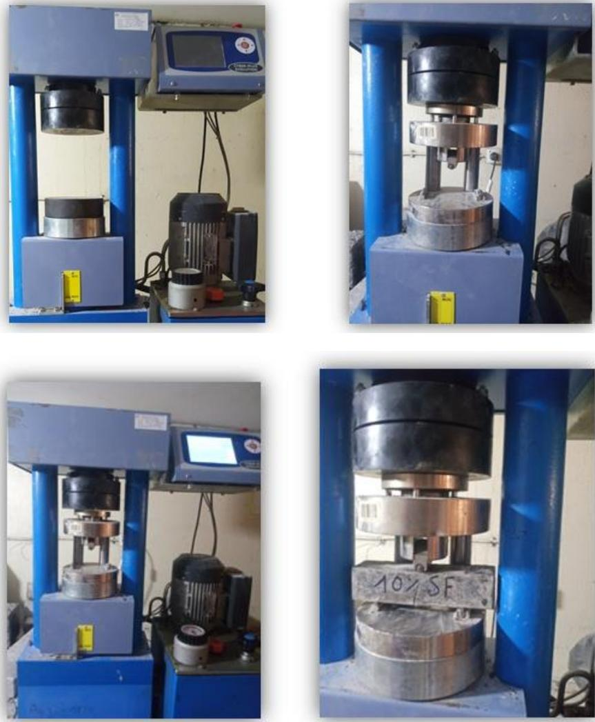
Figure IV.5 La machine d'écrasement à la compression et de flexion
