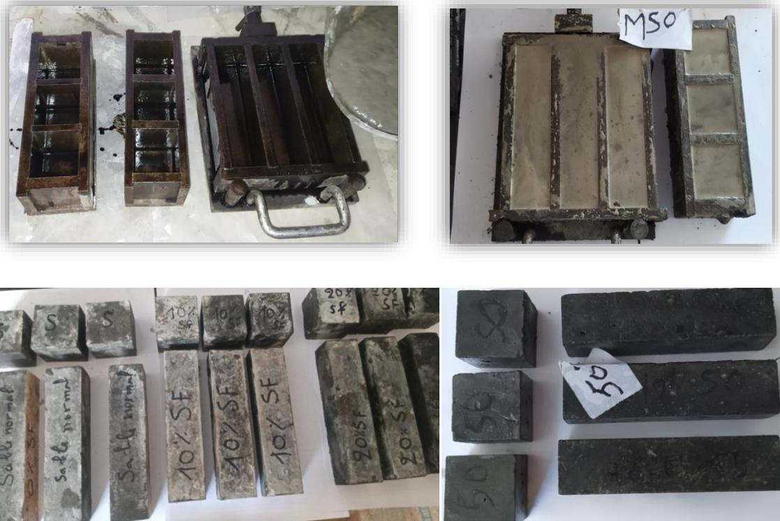
Figure IV.2 Moules de mortier autoplaçant
