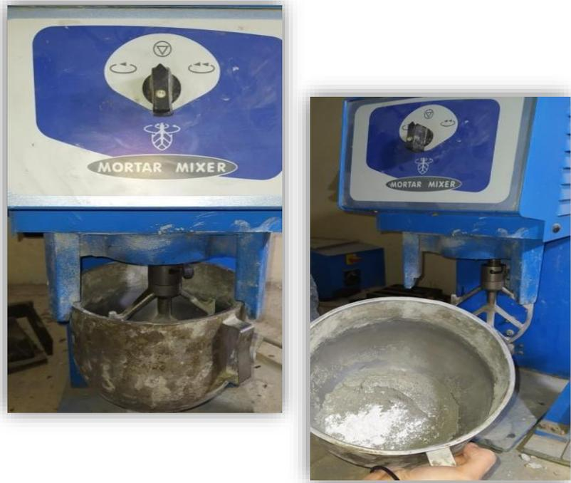
Figure IV.1 Malaxeur pour des mortiers autoplaçants
