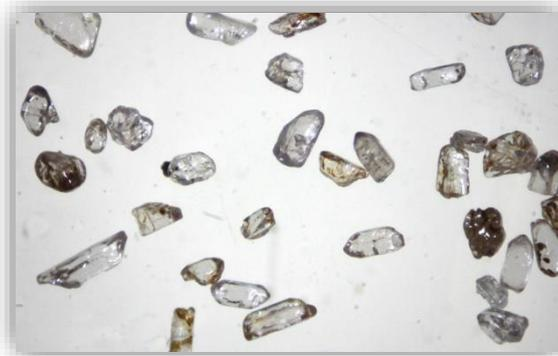
Figure II.3 Grains de sable de zircon [18]
