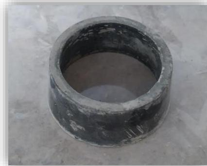
**Figure IV.4** Mini-cône pour mortier
