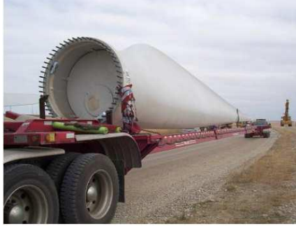
Figure 3. 10. Logistique du transport des pales pour un aérogénérateur de 1.5 MW [9]
