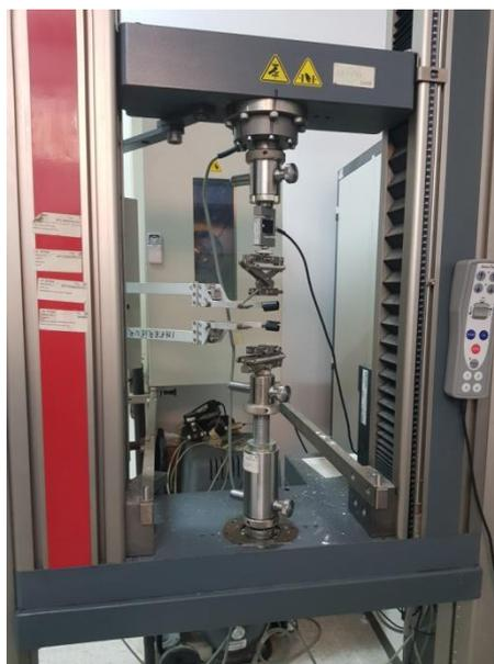
*Figure II.22 : Machine à traction «Zwick-roell» pour films.*
