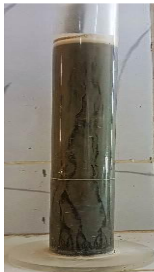
Figure III.7 : Mise en évidence du phénomène d'incompatibilité (Ciment/Adjuvant) rencontré
