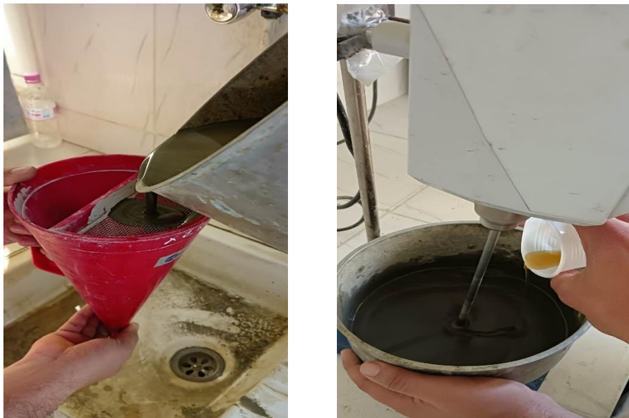
Figure II.9 : Mise en œuvre de coulis adjuvantée
