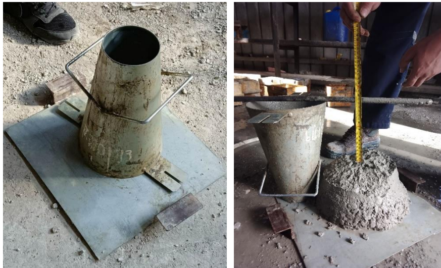
Figure II.18 : Principe de l'essai au cône d'Abrams
