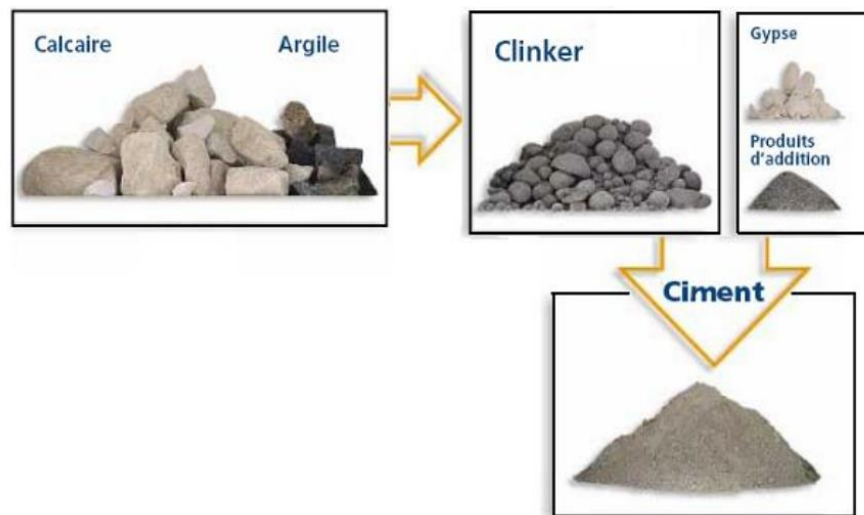
Figure I.4 : Les étapes de la fabrication du ciment [5].
