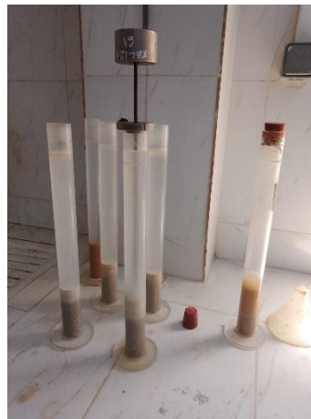
Figure II.13 : Principe de l'essai d'équivalent de sable
