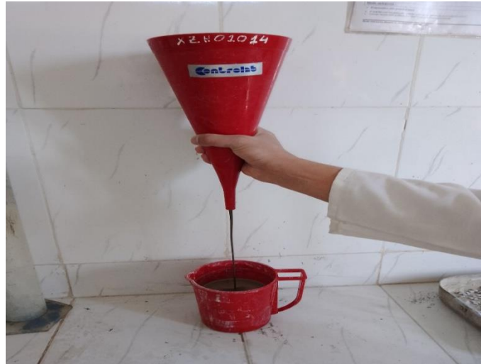
Figure II.8 : Fluidité des pâtes cimentaires à l'aide du cône de Marsh
