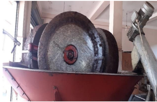
Figure I.8. Broyage des olives avec un broyeur à roues.
