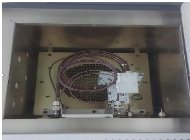
Figure III.10 : Le four et les colonnes de la Chromatographie BRUKER 450-GC.
