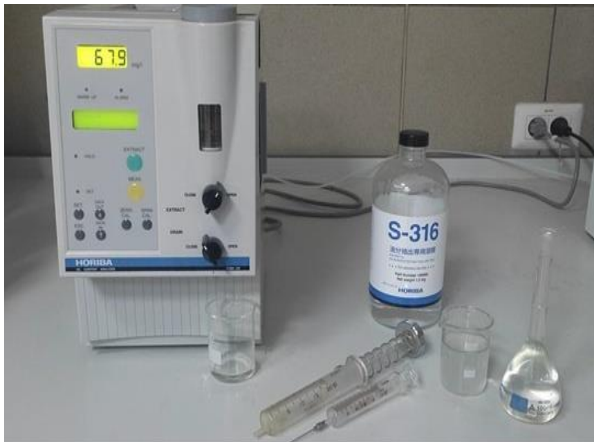
Figure III.19 : Appareil de mesure des hydrocarbures HORIBA OCMA 310.
