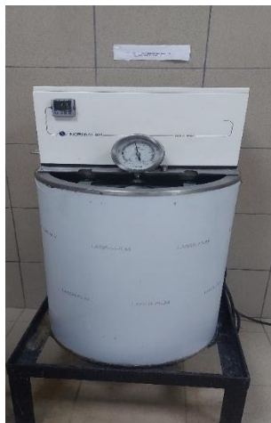
Figure III.15 : Appareillage du la TVR du condensat.
