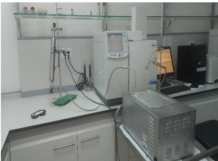
Figure III.11 : Système d'injection dans la chromatographie BEKEUR 450-CG ( A pour le Gaz et B pour le GPL).
