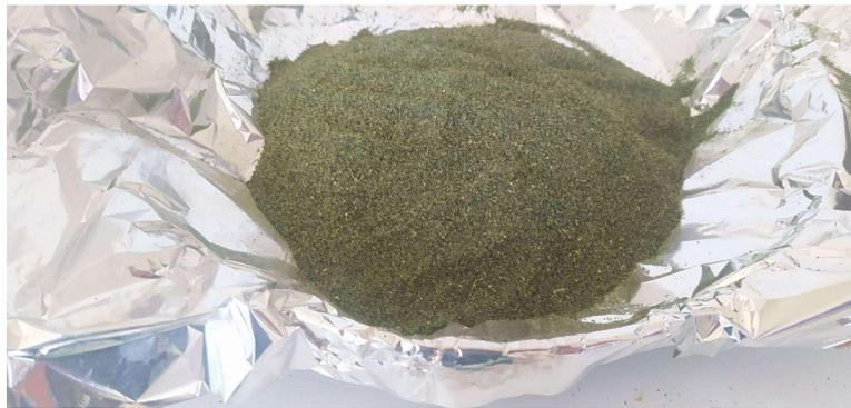
*Figure III. 1 : La poudre obtenue après le broyage et le tamisage*
