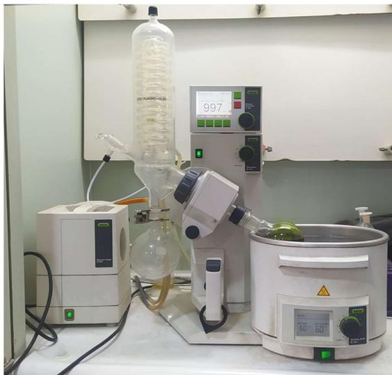
*Figure III. 4 : L'évaporateur Rotatif*
