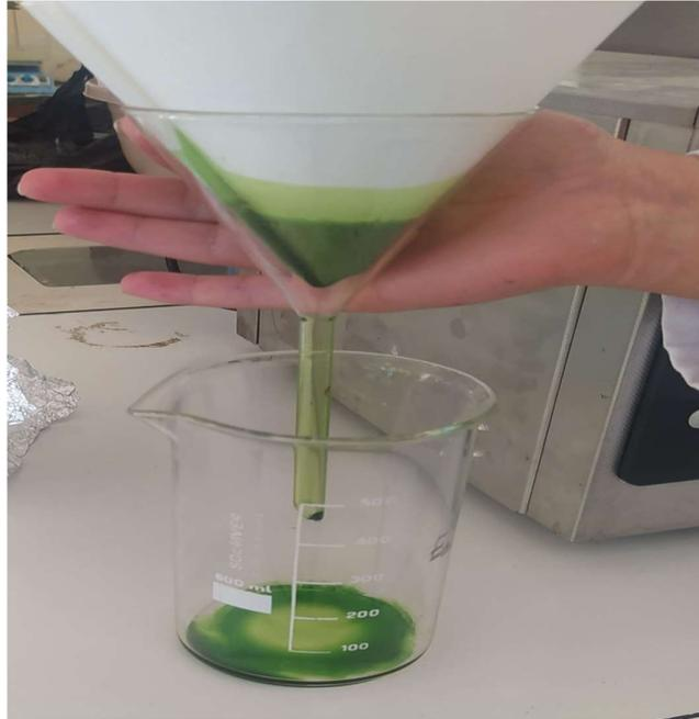
*Figure III. 3 : Filtration d'extrait éthanolique des feuilles d'ortie*
