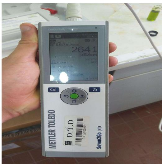
*Figure III. 8 : Le conductimètre portable*
