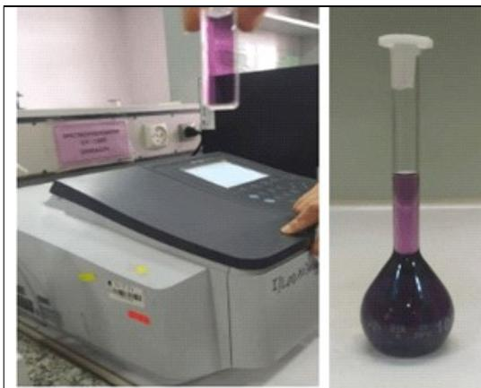
**Figure III. 13 :** Mesure de l'absorbance de la solution témoin
