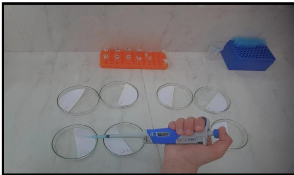
Figure 20 : L'application des dilutions dans la zone traitée et d'acétone dans la zone témoin. (Photo original, 2023).
