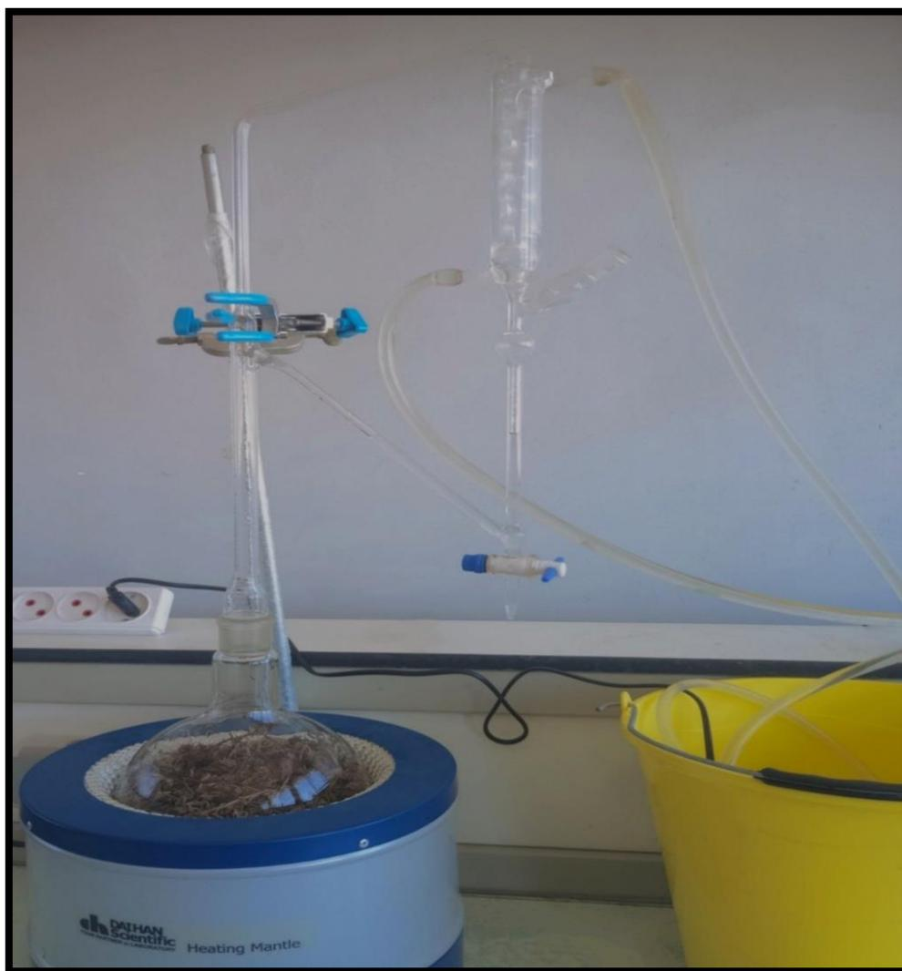
Figure 13 : Hydrodistillation de type Clevenger (Photo original, 2023).
