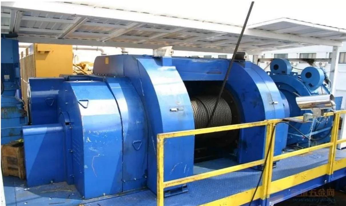
**Figure 1.4** Treuil de forage
