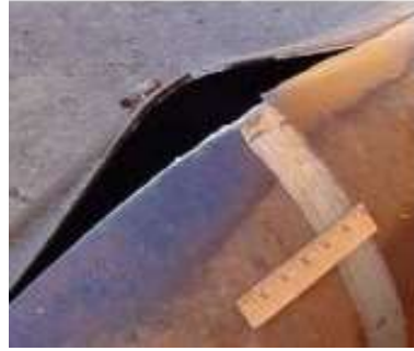
Figure III-9: Exemple d'une défaillance par éclatement d'un tubage[28]
