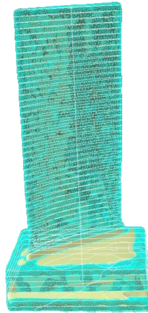
Figure III.14 Modèle surfacique avec le nuage de point d'aube de turbine
