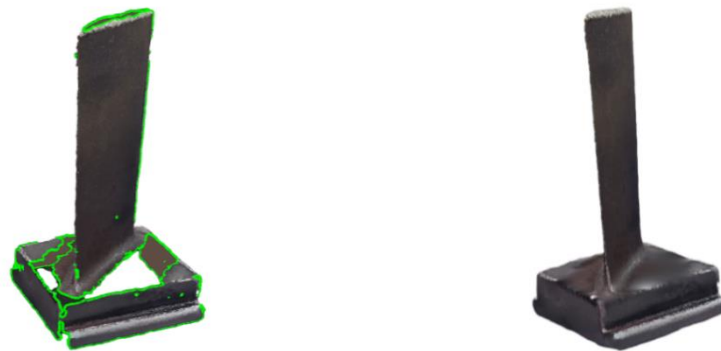
Figure II.14 Correction primaire des défauts de la pièce
