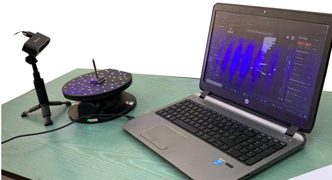
Figure II.6 Installation du matériel du scan
