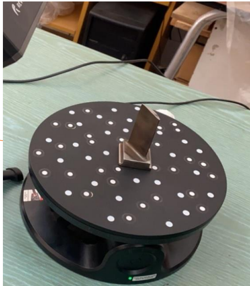
Figure II.4 Une aube placée sur un Dual axis Turntable
