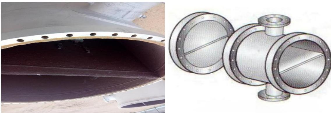
Figure IV-4 : Boîte de distribution (deux passes côté tubes).
