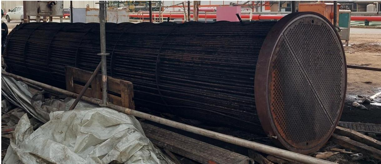
Figure IV-9 : Faisceau tubulaire de l'échangeur.
