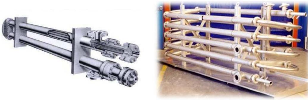
Les tubes sont généralement en acier et les longueurs courantes sont de 3,6 - 4,5 ou 6 m. On utilise également des tubes en verre et en graphite dans des applications particulières. Ces échangeurs utilisés depuis l'origine, conviennent aux produits sales, pour des débits faibles et des températures et des pressions élevées.
