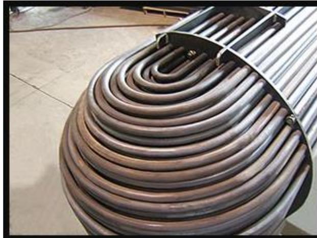
Deux dispositions de tubes sont possibles : le pas triangulaire et le pas carré .La disposition en pas carré offre une plus grande facilité de nettoyage. La disposition en pas triangulaire est plus compacte, donc plus économique.
