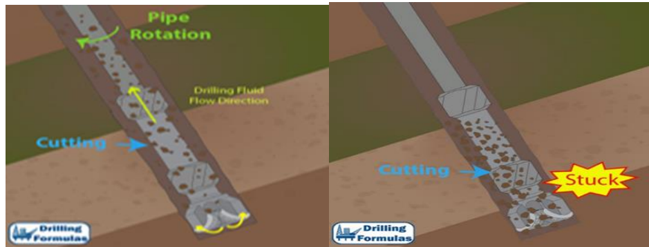
Figure II-1. Blocage de colonnes par accumulation de matière étrangère dans le trou (Harish's, 2015)
