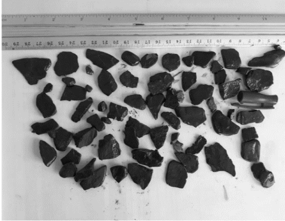
Figure III-12. Signe de cavage dans les tamis lors de coincement dans puits RHAEP-1.
