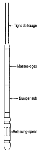
Figure III.23 Garniture de repêchage par l'intérieur.
