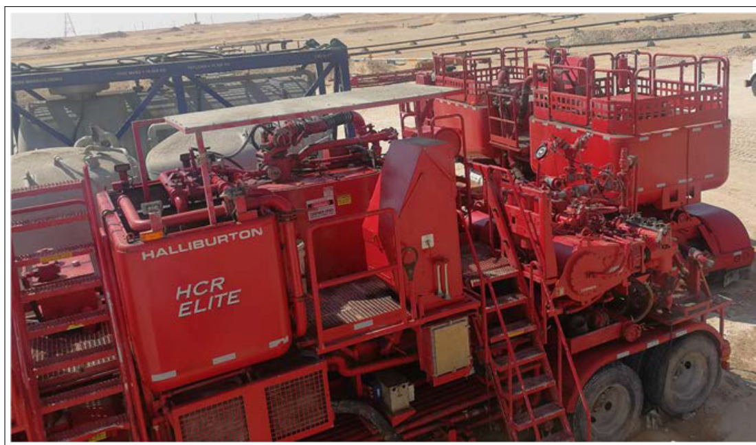
Figure II-19: Une unité de ciment installée sur un appareil de forage sur un site onshore.
