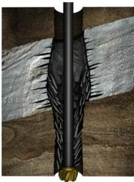
**Figure 2.13** : formations faillées et fracturées.[2]
