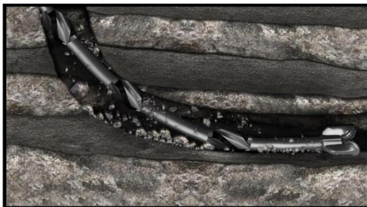
**Figure 4.4 :** Mauvais nettoyage des trous.[20]
