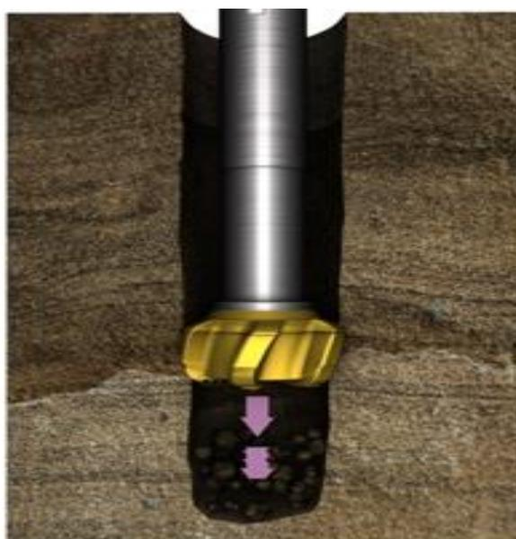
**Figure 2.7 : Diminution du diamètre nominal du trou.[2]**
