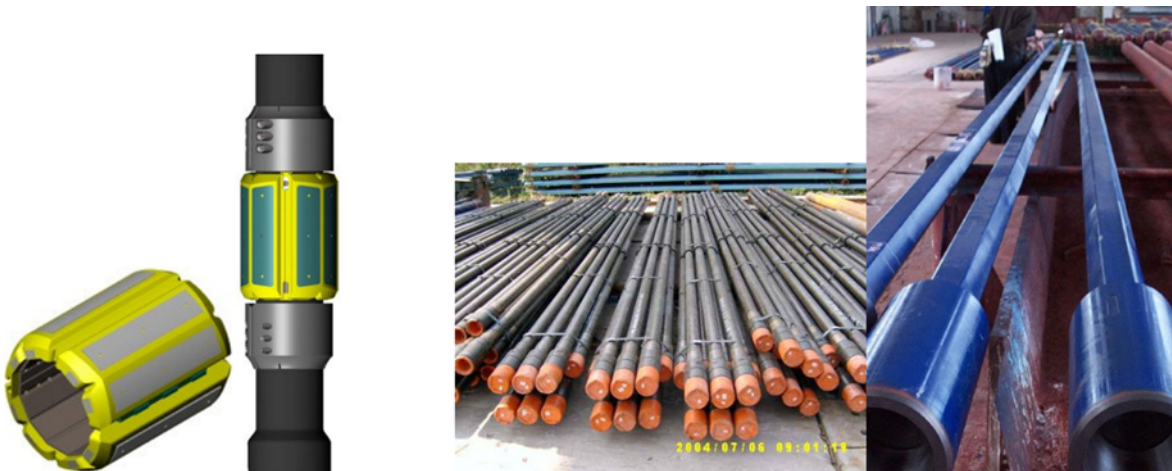
FIGURE 2.22 – a : Incorporation de NRDPP b : Revêtements spéciaux
