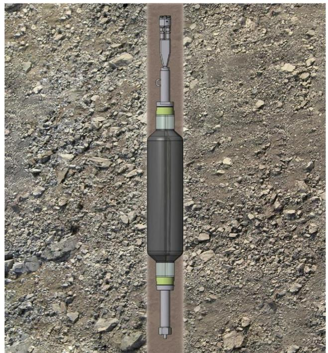
Figure A.III. 5: représente un Inflatable packer dans un puit
