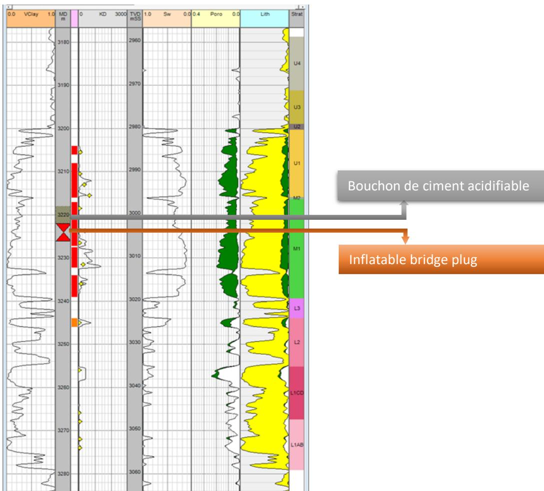
Figure B.II. 23 : Schéma d'un puits vertical avec isolation par inflatable bridge plug
