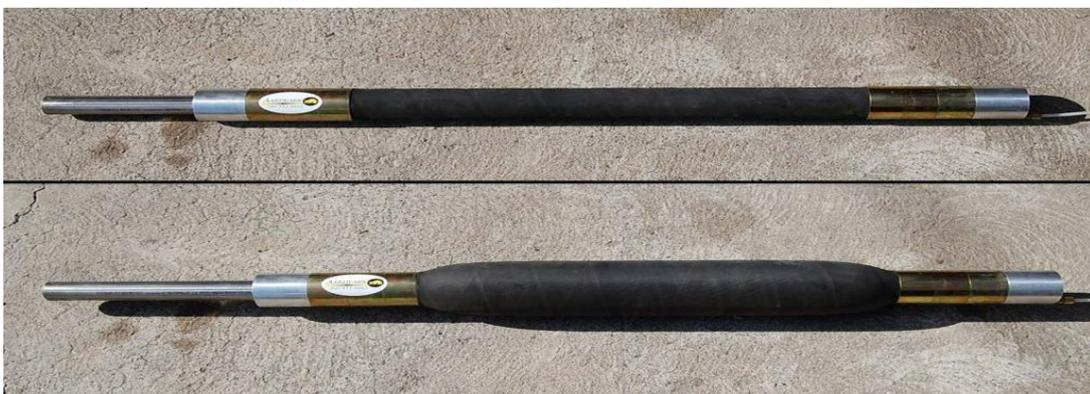
Figure A.III. 6: Inflatable packer en cas d'inflation
