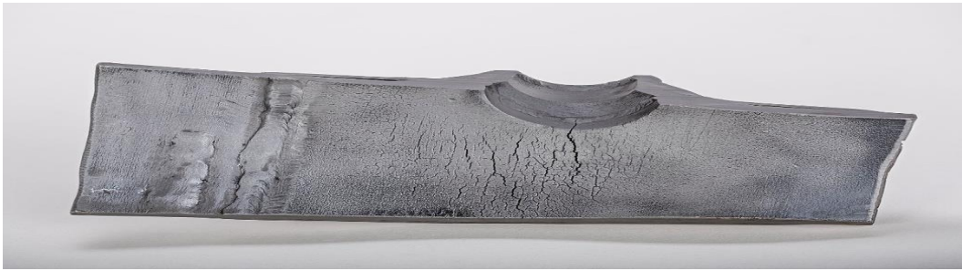
Figure 7 : Fissuration par corrosion sous contrainte et Fissuration induite par l'environnement
